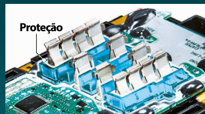
Proteção Estrutura de proteção dos circuitos e terminais A parede de proteção protege os circuitos e terminais contra água e poeira.
