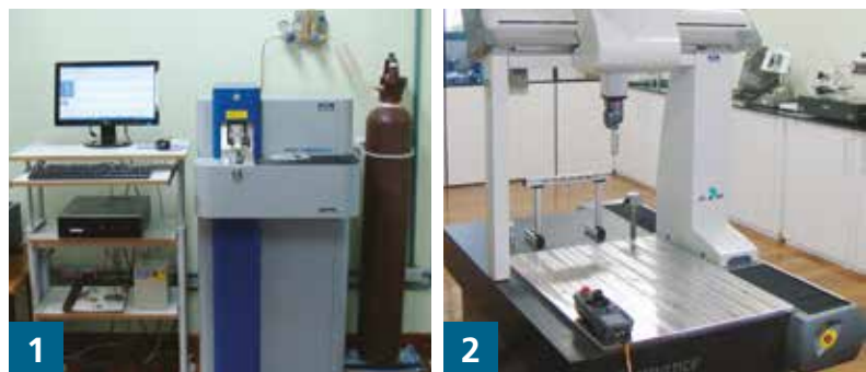
1. Espectrômetro de Emissão Ótica [análise de ligas de alumínio, aço, cobre e zinco] 2. Tridimensional CNC
